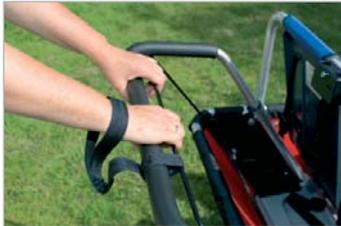
Sicherheit und mehr Komfort bietet die Schlaufe, die den Bremsbügel fest am Handgriff hält. Wird der Handgriff losgelassen, löst sich die Schlaufe automatisch.
